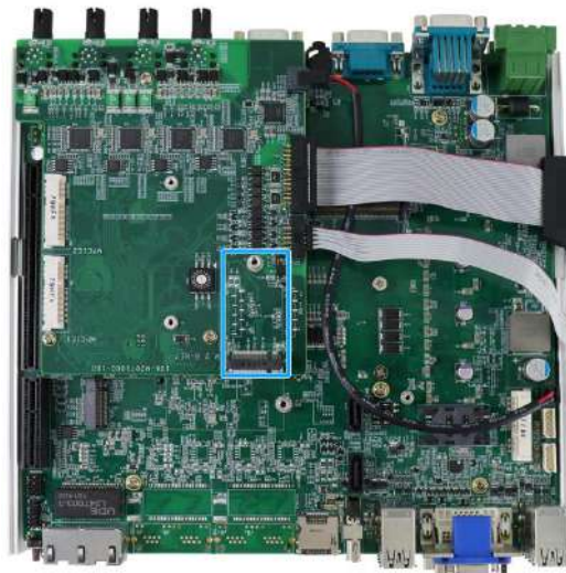
M.2 slot on MeziO™ module
